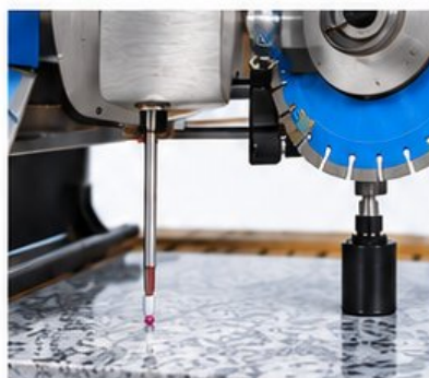
Medição automática da espessura da chapa e do diâmetro do disco (opcional)
