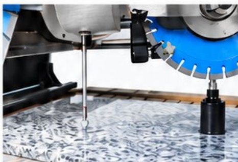
Medição automática da espessura da chapa e do diâmetro do disco (opcional)
